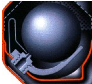
Orificio de Drenaje
